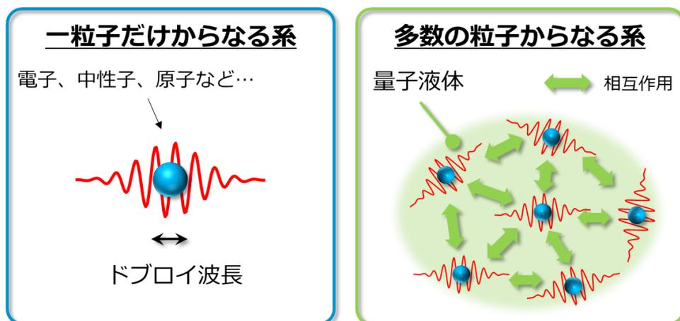
図 1: (左)粒子が一個だけある場合、その粒子の振る舞いは、シュレーディンガー方程式<sup>注5</sup>を解くことによって、理解できます。量子力学によれば、粒子は波動性も持っていますが、その波長をドブロイ波長と呼びます。(右)粒子が多数集合した状態。粒子は、量子力学的に相互作用し、量子液体状態を形成します。量子液体の振る舞いは、粒子一個の場合とは、大きく異なります。
