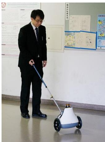
今津講師は、視覚障がい者の方が気軽に安全に一人歩きできることを目指して、車輪付きの杖型ガイドナビ装置を開発中です。ロボットの技術を応用していますが、装置が前進して利用者を引っ張るのではなく、利用者が装置を押しながら進み、装置は車輪のステアリングとブレーキだけを自動で行います。利用者と装置が協力しながら歩くことが特徴です。道案内と安全確認は装置が行うため、利用者は装置を押し歩いて目的地にたどり着くことができるようになります。
