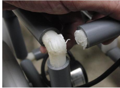
図 2 継ぎ目で割れてしまった部品
