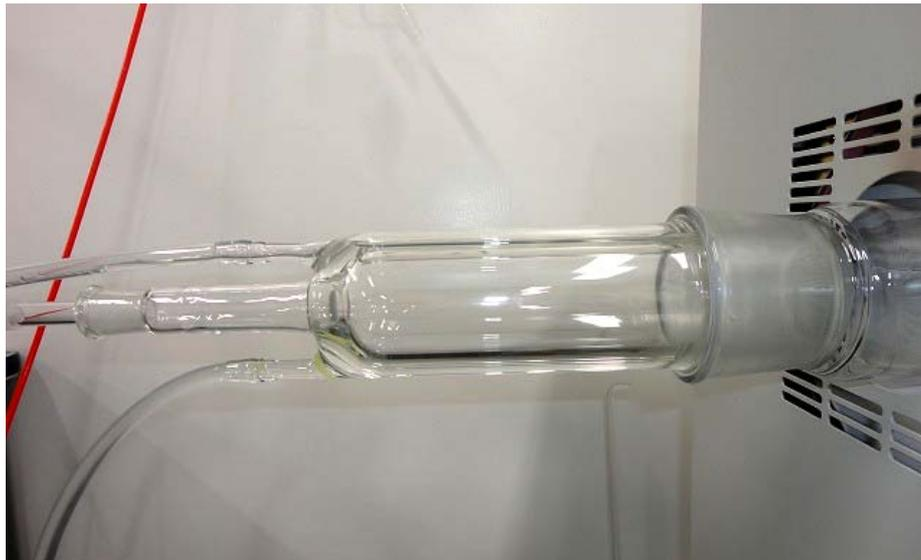
27 水冷式炉芯管試料導入ジョイント
