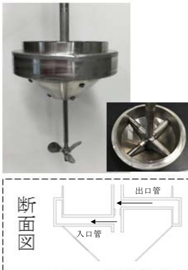
Figure.2 温水循環型 微結晶溶解翼
