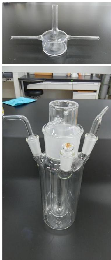
図1 光触媒反応セル。
