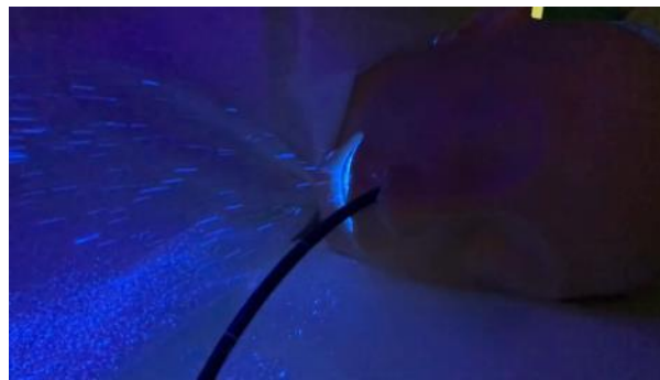
（写真1：被験者（マネキン）にマスクを装着して噴霧器で検査中の咳を再現）
