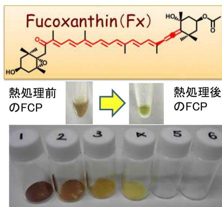
集光に重要であると着想しました。これよりフコキサンチンの集積で緑色光の集光を再現しようとしています。フコキサンチンは多孔質シリカに吸着させることにより画期的に耐久性が得られます。この吸着を制御することにより、フコキサンチンの集積に依存する電子励起状態の変化を観測する事が出来ました。
