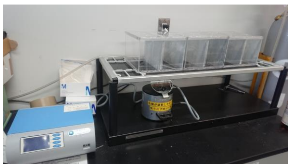
図 1. Dynamic Plantar Aesthesiometer 37540。ラットの足底を器械刺激し、逃避閾値を測定する。
