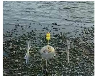
図4 水面と陸を移動できるロボット
