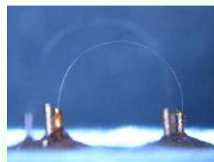
極微細超伝導線(NbTi 直径1~3 μm) 極微細金属線で、超流体の乱流遷移を捉えることができます。
