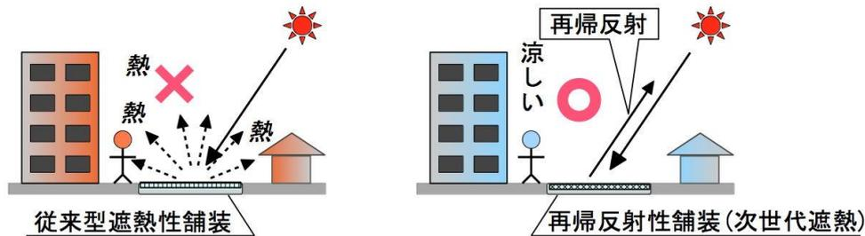
本シーズでは、プリズム、球状レンズにつぐ第3の方式として、これまであまり注目されることのなかった、表面凹凸方式による再帰反射に注目し、その設計手法を確立した。
